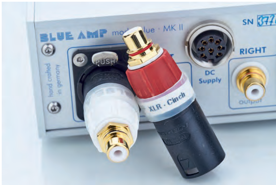
Bei Bedarf liefert Rolf Becker hochwertige Adapter von Cinch auf XLR für den symmetrischen Eingang
